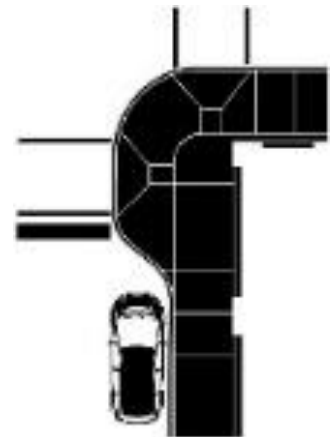
Ejemplo de ampliación de bordillo
