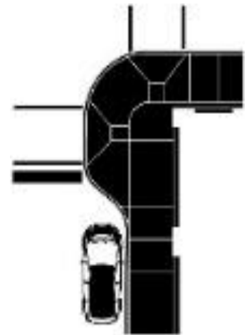
Ejemplo de ampliación de bordillo
